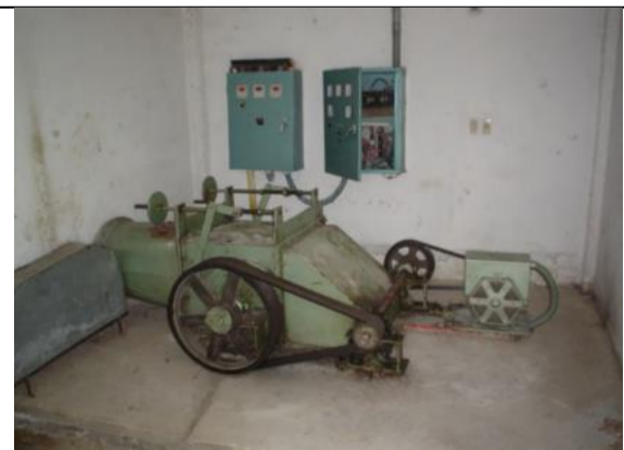
Turbina flujo Cruzado, 850 l/s, 4.5 m de cabeza Febrero 2004
